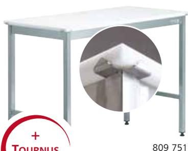
Costruzione in acciaio inossidabile. Piedi 35 x 35 mm con piedi anti-sdrucchiolo. Cintura 60 x 30 mm. Altezza 900 mm. Piano di taglio amovibile in polietilene, spessore 25 mm. Certificazione NF - Igiene Alimentare.
