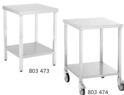
Costruzione saldata in acciaio inossidabile. Basamenti in tubo 40 x 40 mm con piedi regolabili 0/+25 mm. Piano spessore 15/10 mm. Ripiano spessore 12/10mm. Carico massimo ammissibile: 150 kg. Tavoli su ruote: con calotta in acciaio elettro-zincato Ø 125 mm di cui 2 con freno.
